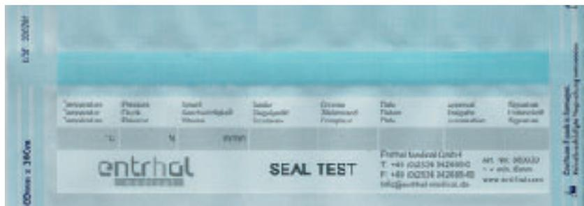
B) La saldatura risulta non omogenea, probabilmente sono presenti micro-particelle di materiale sui rulli.
