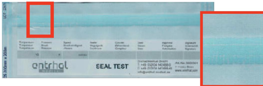
D) La saldatura presenta strisce verticali in presenza di fori o lacerazioni del materiale
