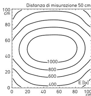
Intensità di illuminazione es. di due apparecchi da 15 W ruotati di 90° con diffusore CDP (distanza delle teste dei due apparecchi ca. 90 cm)
