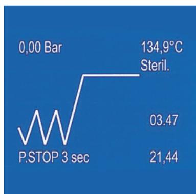
Sole BA controlla e registra ogni step del proprio lavoro: dal controllo iniziale della qualità dell'acqua al monitoraggio costante di pressione, temperatura e tempi del ciclo di sterilizzazione, avvisando l'operatore in caso di anomalia.
